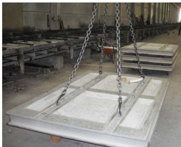
Foto 2 – Formação das pilhas dos painéis para posterior armazenamento no exterior
